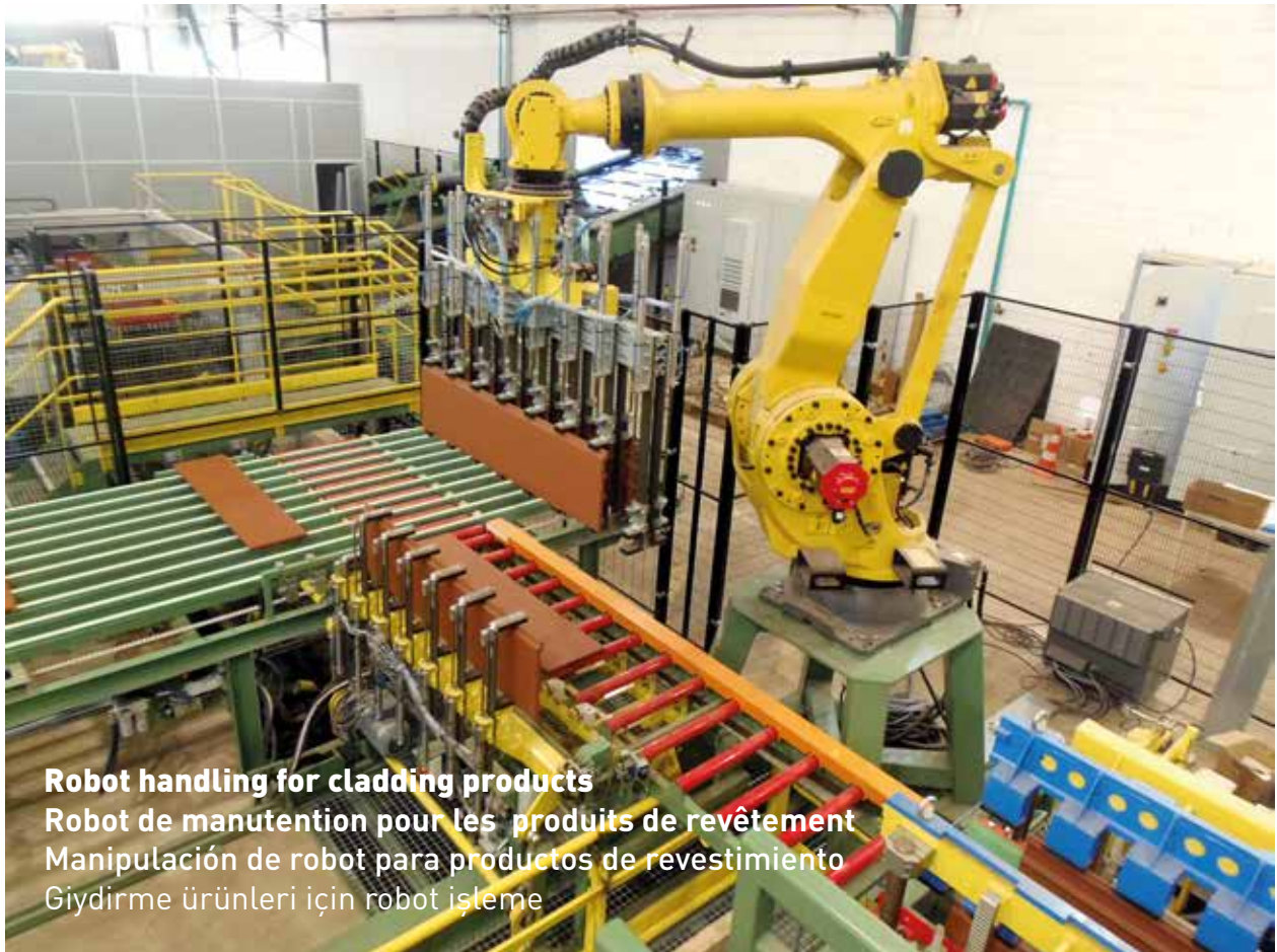
Robot handling for decorative product palletizing Robot de manutention pour la palettisation des produits décoratifs Manipulación con robot para el palletizado de productos cerámicos decorativos Kiremit tesisi U kasetli firm arabası şarjı
